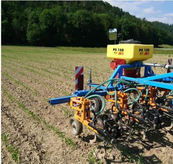
Sägerät auf Hackgerät
