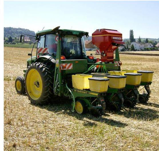
Sägerät auf Sämaschine
